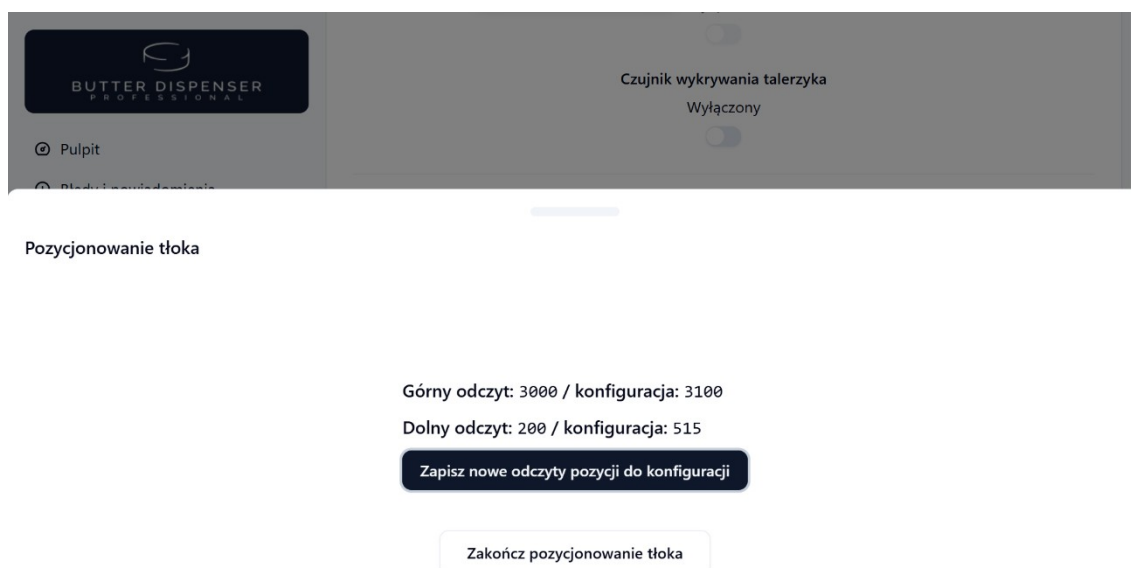
Rysunek 30. Tryb obsługi – procedura bazowania tłoka, zapisywanie nowych odczytów pozycji do konfiguracji
